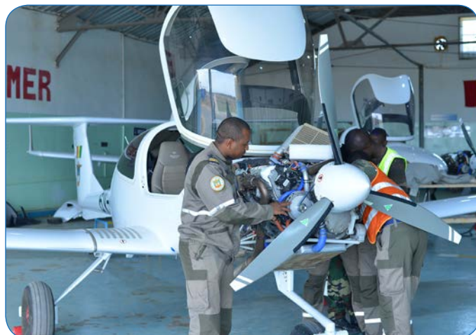
TRAVAUX DE MAINTENANCE SUR LE DA40 NG
